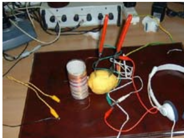
La foto dimostra che anche da un limone si può ottenere energia elettrica, piantandoci una barretta di rame e una di zinco: una funge da polo positivo e l'altra da polo negativo ed è possibile ottenere una piccola batteria. (Foto estrapolata dal sito http://www.adiprospero.it/corsi/elettronica/lezione9/index.html ).
