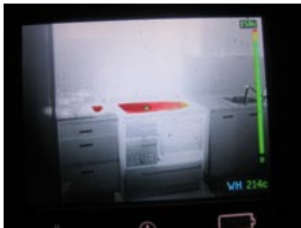
Funzionamento delle termocamera con scala di grigi, bianco = caldo, rosso sopra 150°. Gas e focolare accesi, sulla dx rubinetto acqua fredda aperto, gradi al centro piastra 214. Foto di Rudi Torresani. Anno 2013.
